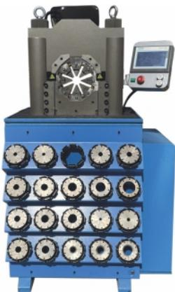
Промышленный опрессовочный станок с усилием обжима 360 тонн. Предназначен для опрессовки рукавов высокого давления до DN76 (3") – 6 оплеточной конструкции. DN102 (4") – индустриальные рукава. Оснащен электронной системой управления через экран Touch Control.
