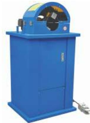
Зачистной (окорочный) станок для мастерских мощностью 0,75 кВт. Предназначен для удаления внешнего и внутреннего слоя рукавов высокого давления до 50 DN. Оснащен новой системой удаления внешнего слоя за счет центробежной силы, не требует тонкой настройки, ножи сами врезаются в мягкую резиновую часть. Комплектуется ножами для внешней и внутренней зачистки 1/4"-2", педаль.
