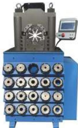
Промышленный опрессовочный станок с усилием обжима 360 тонн. Предназначен для опрессовки рукавов высокого давления до DN76 (3") – 6 оплеточной конструкции. DN102 (4") – индустриальные рукава. Оснащен электронной системой управления через экран Touch Control. В комплект входит: педаль, инструмент для быстрой смены кулачков, кулачки и магазин для их хранения.
