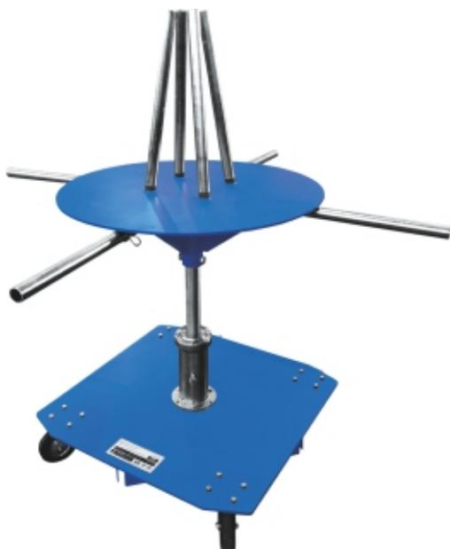
Стенд для размотки и намотки рукавов высокого давления. Имеет 4 колеса со стопорами для перемещения и фиксации стола. Оснащен 4 удлинителями для удержания бухт большого диаметра.
