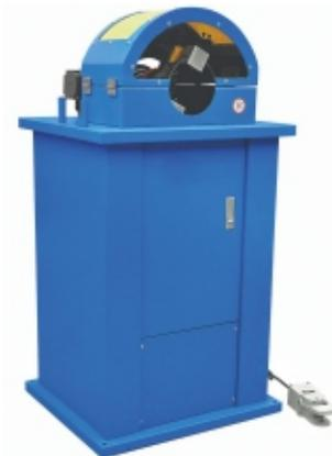
Зачистной (окорочный) станок для мастерских мощностью 0,75 кВт. Предназначен для удаления внешнего и внутреннего слоя рукавов высокого давления до 50 DN. Оснащен новой системой удаления внешнего слоя за счет центробежной силы, не требует тонкой настройки, ножи сами врезаются в мягкую резиновую часть. Комплектуется ножами для внешней и внутренней
